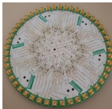
Fig. 3. Carte de commutation des colonnes et capteurs
