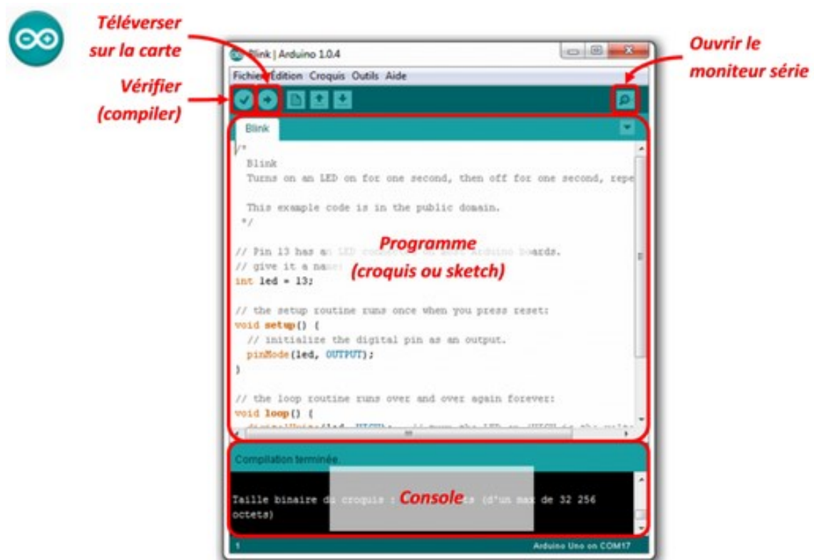
Figure 102 : Interface IDE Arduino
