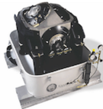
FIGURE 5.30 – Gradiomètre aéroporté Air-3D FTG™ commercialisé par ©Lockheed Martin. Droits réservés ©Lockheed Martin.
