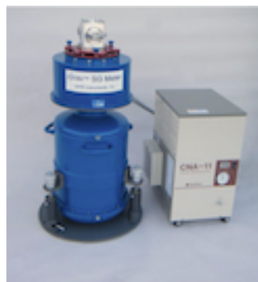
FIGURE 5.16 – Gravimètre supraconducteur « igrav™ » de ©GWR Instruments. Droits réservés ©GWR.
