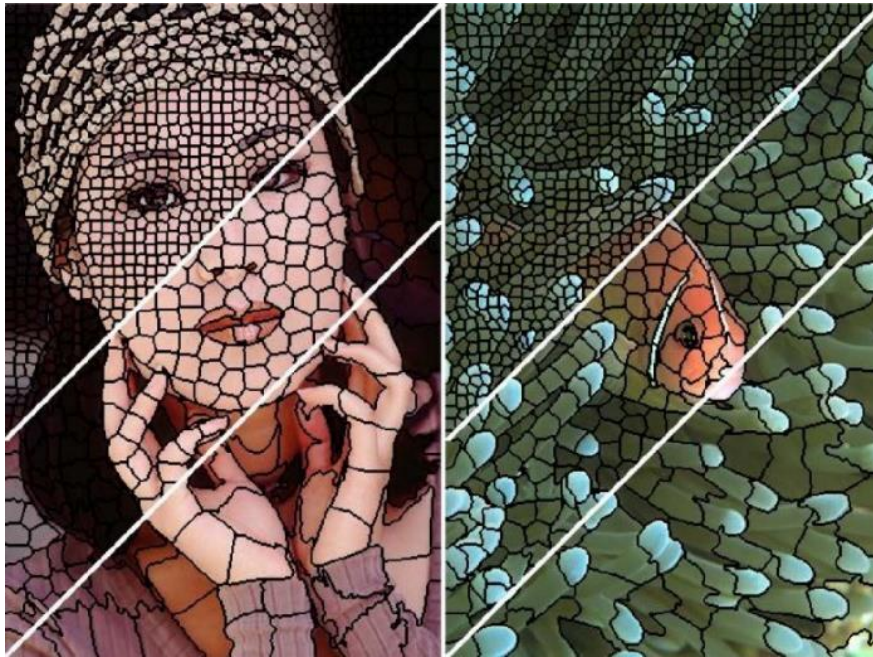
Figure 86 : Résultats de la segmentation d'images en superpixels avec l'algorithme SLIC en prenant le nombre de superpixels souhaités « k » égale à 64, 256 et 1024 de bas en haut sur les 2 images. Extrait d'Achanta et al. (2012).
