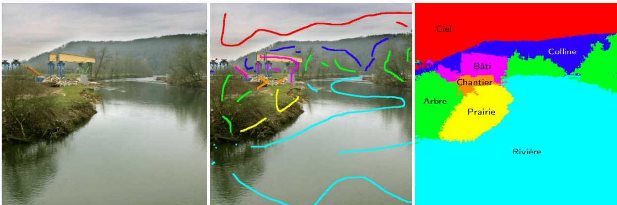
Figure 87 : Classification supervisée des superpixels pour une segmentation sémantique de l'image d'un paysage en 8 classes : arbre, prairie, rivière. Extrait de Mathieu et al. (2016).
