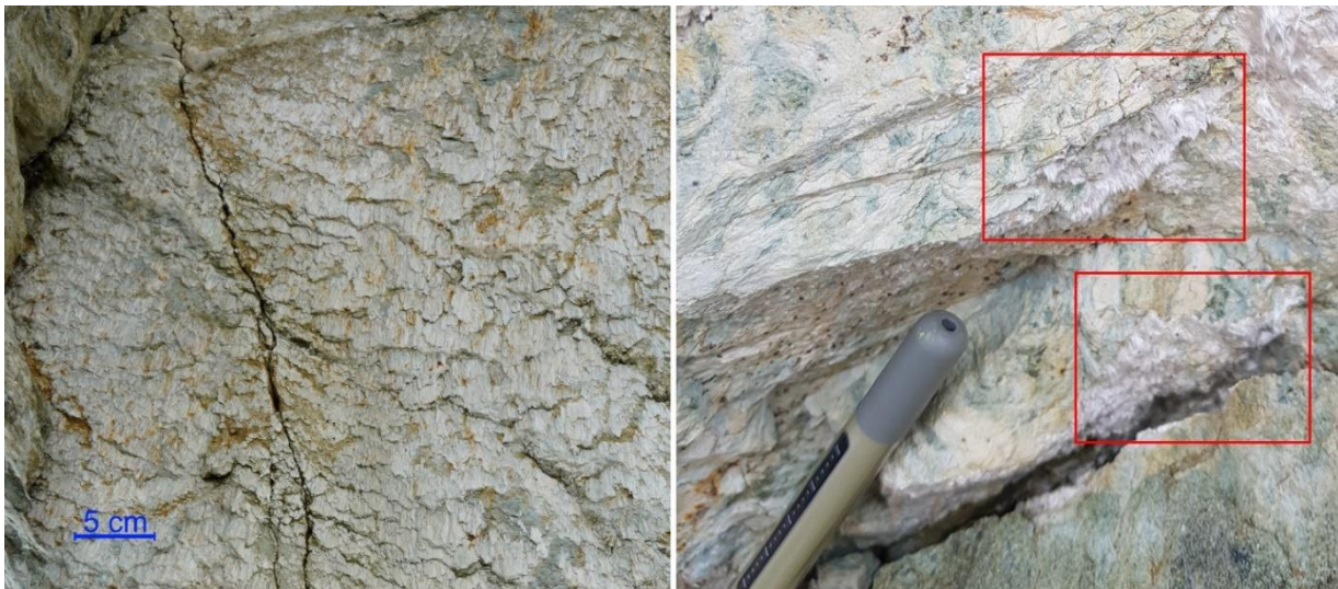
Figure 7 : Fibres d'amiante de type « Slip Fiber » (SF) (à gauche) et « Cross Fiber » (CF) avec un stylo pour l'échelle (à droite).
