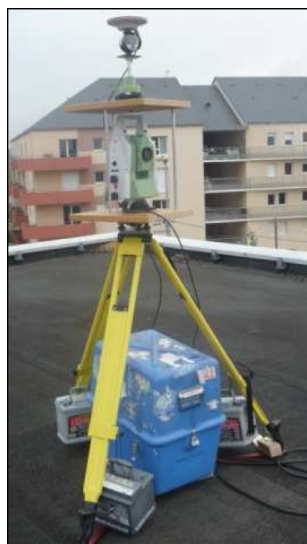
FIGURE 9 – Premier prototype de système permettant de positionner un récepteur GNSS à la verticale d'une station totale.
